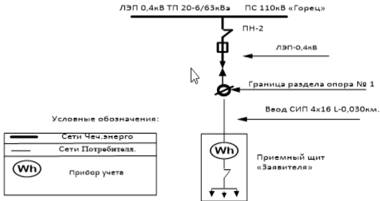
Рисунок 8 - Схема электроснабжения артскважины с. Мартан-Чу, ул. С. Умхаджиева
