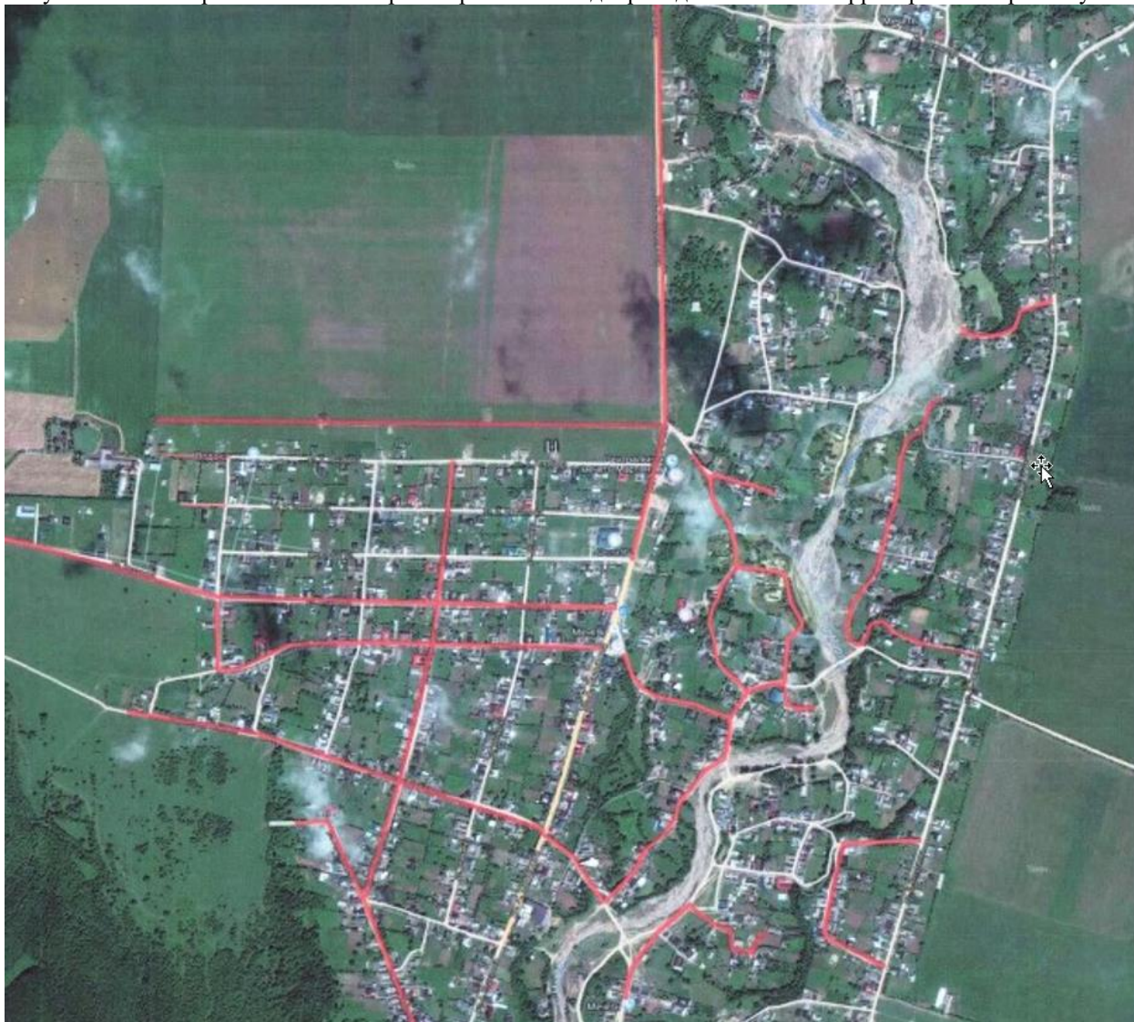
Рисунок 5 - Схема расположения запроектированных водопроводных сетей на территории с. Мартан-Чу
